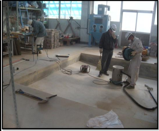
【写真 2】砂場の砂の撤去後の様子。この後、より粗い砂に代替したところ粉じん曝露は減少した。
