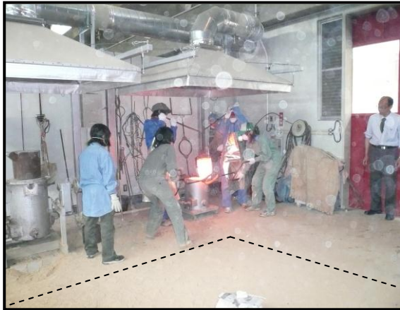
【写真 1】排気装置設置後の作業。鉛曝露は減少したが、粉じん曝露は続いた。点線の下が砂場。
